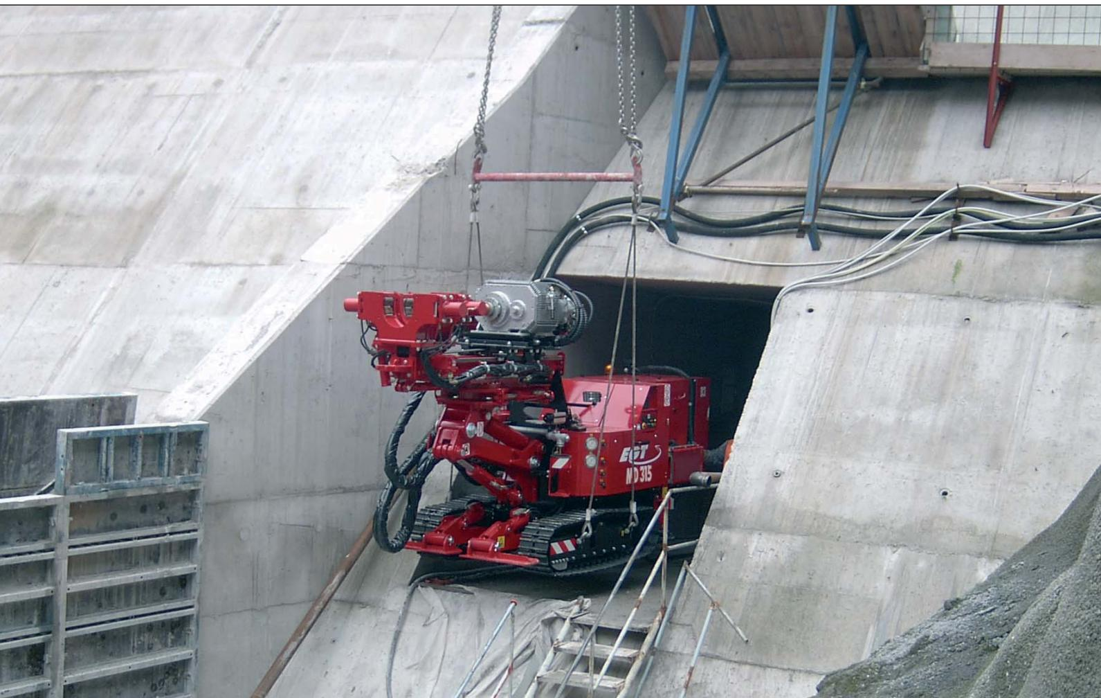
Perforatrice polifunzionale certificata CE versatile e con elevate doti di manovrabilità, utilizza le più avanzate tecnologie meccaniche ponendole al servizio della perforazione nell'ambito dell'ingegneria civile. Le perforatrici Class3 sono di tipo brandeggiabile e progettate per eseguire operazioni di perforazione verticale, sub-verticale e radiale.
