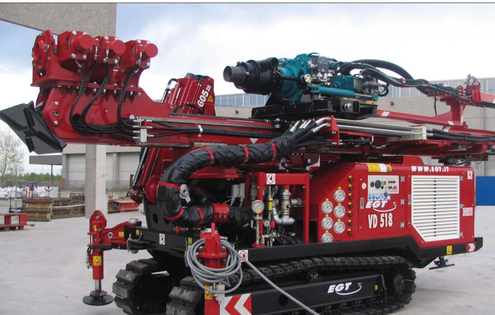
Perforatrice ad elevate prestazioni la **VD Class5** garantisce un'ampia versatilità sia in termini di caratteristiche che di possibili allestimenti: applicabilità di doppia rotary superiore fino a 15.000 Nm e inferiore fino a 32.000 Nm, caricatore magnetico per doppia asta di concezione EGT. Le perforatrici **VD Class5** sono di tipo verticale, e grazie ad uno speciale snodo anteriore, permette inclinazioni trasversali del mast  $\pm 90$  gradi su entrambi i lati.
