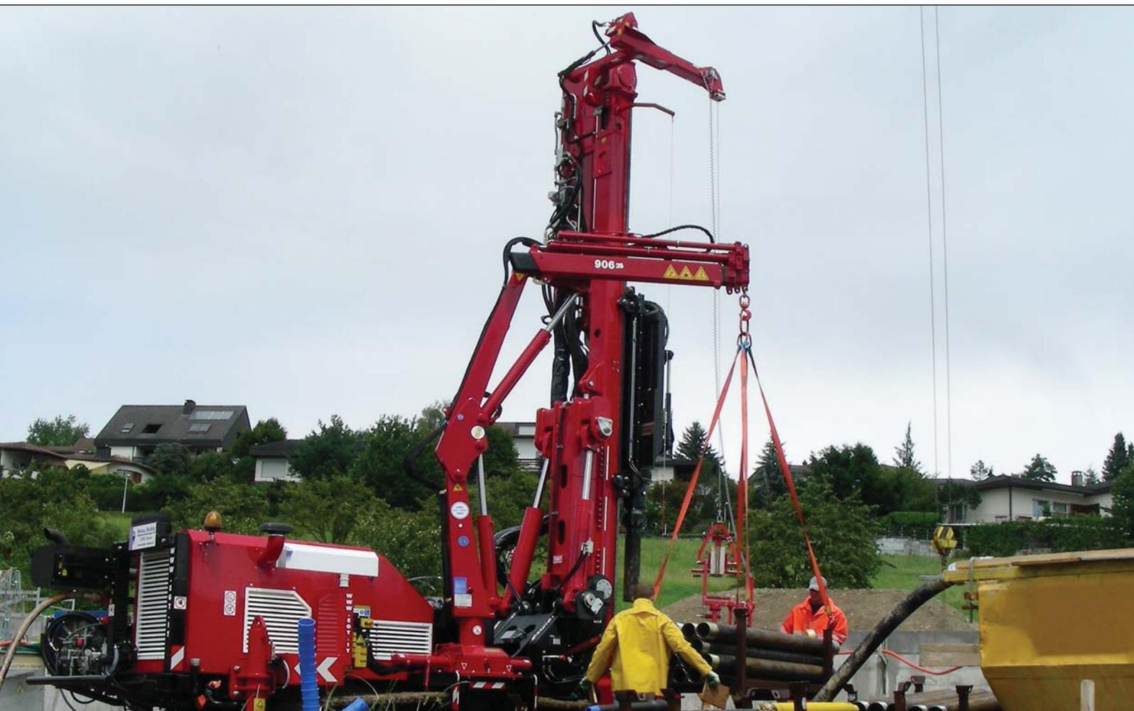
Perforatrice ad elevate prestazioni la **VD\_Class8** garantisce un'ampia versatilità sia in termini di caratteristiche che di possibili allestimenti: applicabilità di doppia rotary superiore fino a 15.000 Nm e inferiore fino a 32.000 Nm, caricatore magnetico per doppia asta di concezione **EGTECHNOLOGY**. Le perforatrici **VD\_Class8** sono di tipo brandeggiabile che, grazie ad uno speciale snodo anteriore, permette inclinazioni trasversali del mast  $\pm 90$  gradi su entrambi i lati.
